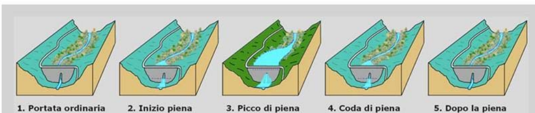
Fig. 30. Schema di funzionamento degli invasi montani di laminazione (sbarramenti a bocca tarata). Lo scopo è trattenere temporaneamente nell'invaso le portate eccedenti una certa soglia (quelle che produrrebbero esondazione a Carrara), rilasciandole in seguito, quando il picco di piena è già passato e le acque possono transitare a valle senza provocare danni. 1: lo sbarramento ha un'apertura sul fondo (qui disegnata verticale, ma solitamente orizzontale) che lascia passare interamente le portate ordinarie. 2: all'arrivo di una piena non tutta l'acqua riesce a passare dalla bocca tarata, perciò il livello nell'invaso inizia ad aumentare. 3: col picco di piena si raggiunge il massimo livello nell'invaso. 4: passato il picco di piena, l'acqua invasata continua a uscire e il livello nell'invaso cala. 5: nel giro di qualche ora (per il Carrione) l'invaso è nuovamente vuoto. Non si tratta quindi di laghi, ma di bacini completamente vuoti per diversi anni, salvo attivarsi per qualche ora in occasione di piene superiori a una certa soglia.
